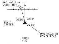
E 1/4 COR. SEC. 25, PLACED A 5/8' DIA STEEL REROD W/DRANGE CAP MARKED 'WEBER PLS 15084'
