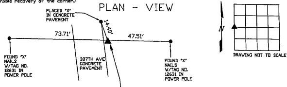
WEST 1/4 COR., SEC. 25, T85N R4E OF THE 5TH P.M. PLACE 5/8' REROD W/ORANGE CAP NO. 15084
