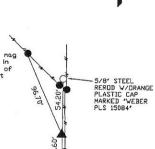
SE COR. NW-NE SEC. 7 T.86N, RIE. OF THE STH P.M. PLACED 5/8' STEEL REROD W/ORANGE PLASTIC CAP MARKED 'WEBER PLS 15084'
