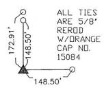
SW COR., NW-NW, SEC. 6 T.86N. R.4E. DF THE 5TH P.M. PLACED 5/8" REROD W/DRANGE PLASTIC CAP NO. 15084.
